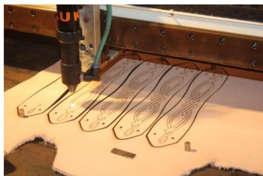
Figure 3.2. Machine de laser CO<sub>2</sub> en marche (<http://www.carreauarbalete.com>)
