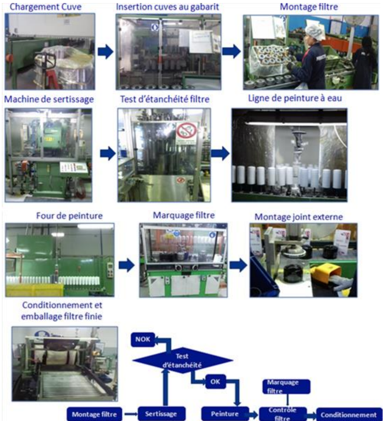
Les différentes étapes d'assemblage et de montage de filtre fini
