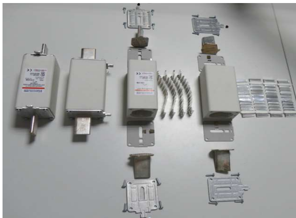
Figure 7 : les composants d'un fusible NHGPV
