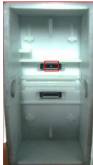
Bulle d'air dans la lentille
