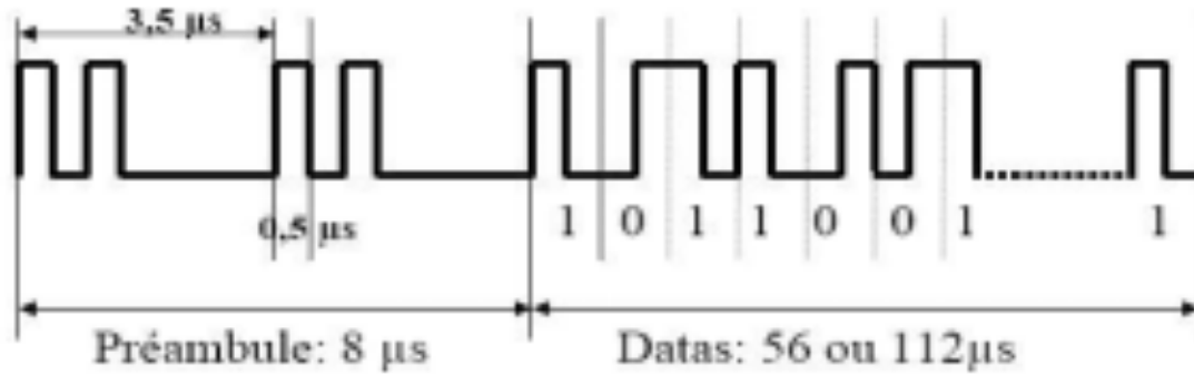
Figure 65: structure de réponse mode s
