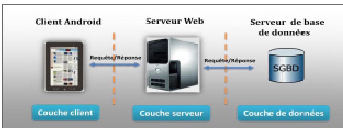
Figure 9: Architecture matériel du système
