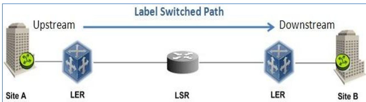
Figure 2.3 : Principe de la commutation de label
