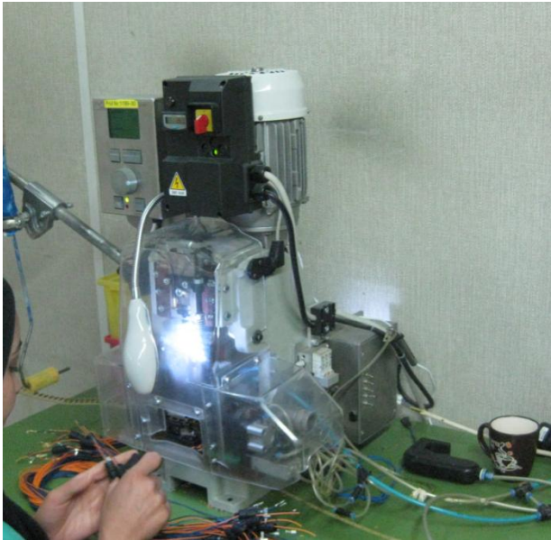
Figure 10: Poste de sertissage 2 après modification
