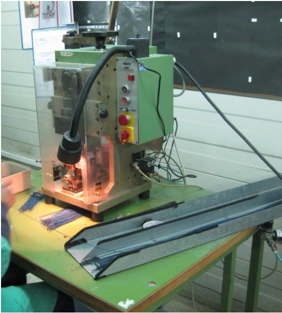
Figure 8: Poste de sertissage après modification
