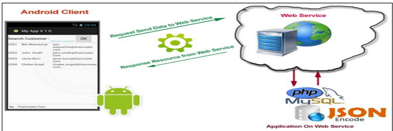
Figure 19: Description matérielle de l'application
