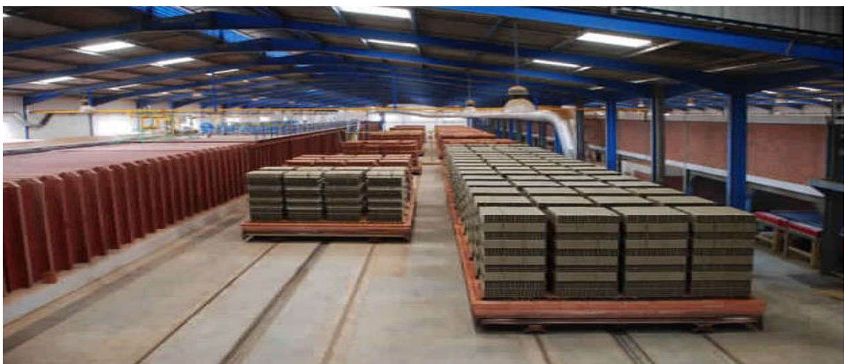
Figure 2 : Les transbordeurs pour la manutention automatiques des wagons
