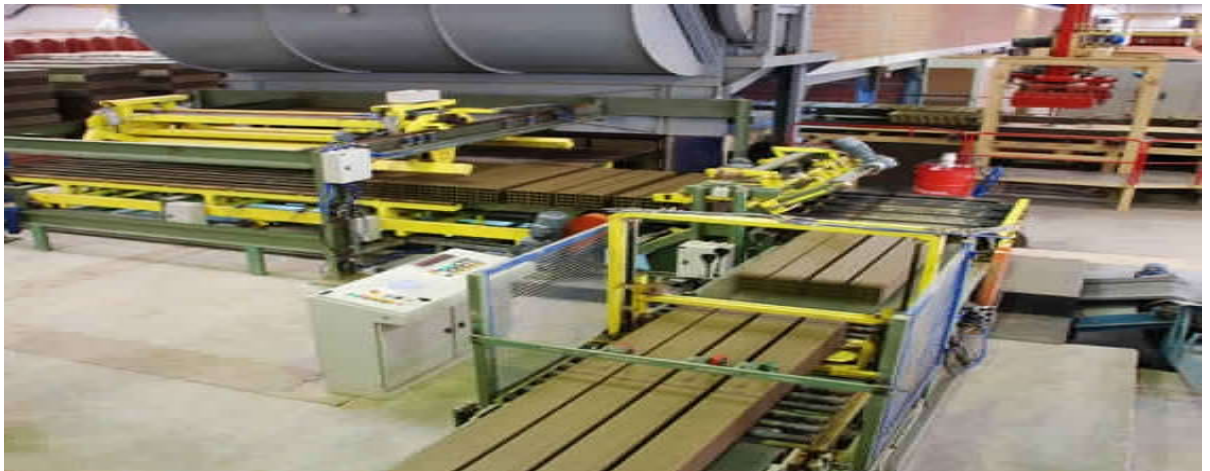
Figure 4 : Coupeur Multi fils de haut rendement (cadence) et de fonction régulier Affaire Briqueterie BBM :
